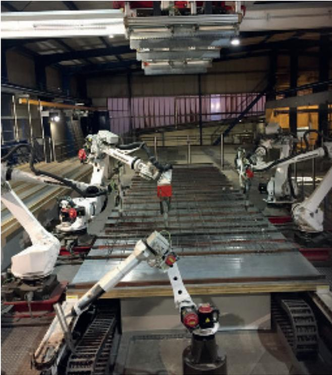
*Dreidimensionaler Bewehrungskorb (Korbwand®) wird komplett und ohne weitere manuelle Tätigkeiten von Robotern zusammengesetzt und zug- druckfest verschweißt.*
