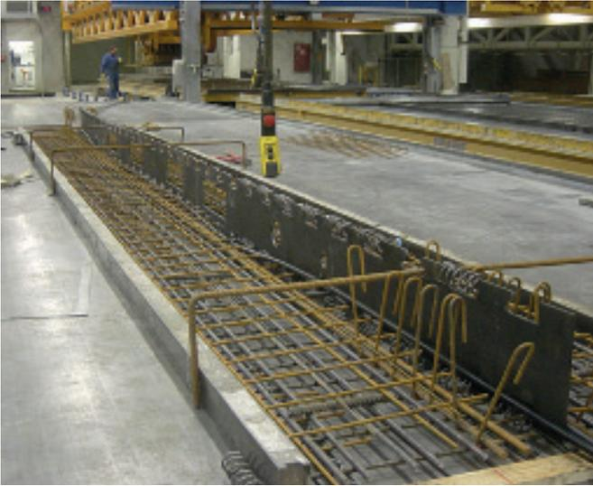
*Hohe Tragfähigkeit durch Stahlverbundkonstruktion in Ergänzung mit einer vorgespannten Bewehrung – lokal hohe Tragfähigkeit für große Öffnungen in den Rippen.*
