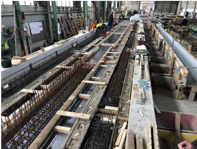
Bild 9 Sicht auf das mobile Spannbett zur Herstellung der vorgespannten Gurtstreifenplatten View of the mobile tensioning bed for the production of the pre-stressed belt strip plates
