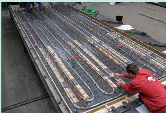
Qualität „Made in Germany“: Im Fertigteilwerk werden alle Ceiltec-Deckenkomponenten am Stück angefertigt.
